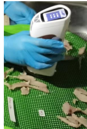
Figura 8. Monitoreo de colorimetría en muestras frescas y secas
