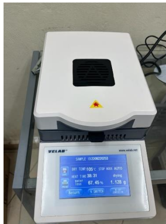
Figura 5 Medición de porcentaje de humedad
