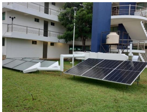
Figura 1. Secador solar con hibridación de tecnologías solares
