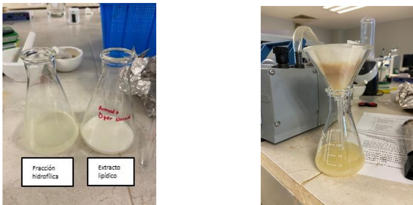
Figura 17. Extracción con Bligh & Dyer modificado
