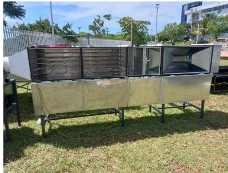
Figura 2. Secador solar tipo túnel.
